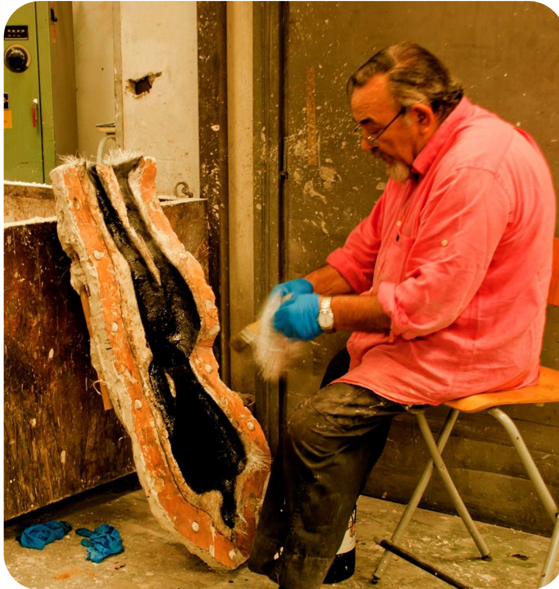
Incorporación de la fibra de vidrio sobre el poliéster. Se abre para hacerla más fina y adatarla mejor a las formas del molde
