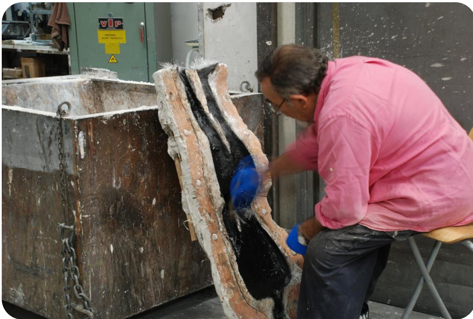
Incorporación de la fibra de vidrio aplastándola con una brocha
